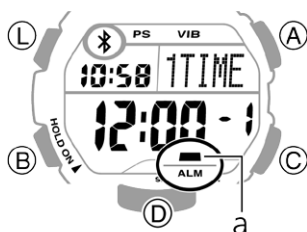
a. Alarm indicator
